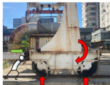
Figura.20 Sistema estructural con biela interna o empotramiento móvil.
