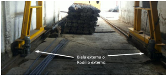
Figura.48 Idealización de estructura con empotramiento móvil externo.
