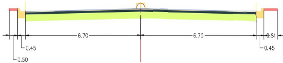
Figura 90. Perfil transversal de la Calle Rondón, Manzana #6.
