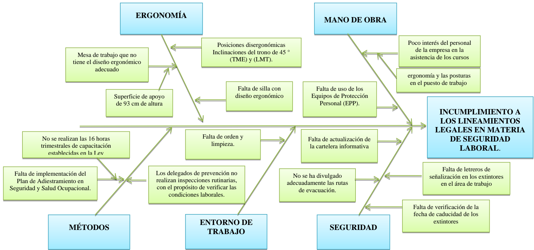
Figura 16. Diagrama de causa-efecto como resultados obtenidos en el diagnóstico de las actividades laborales en el área de control de calidad de la empresa M & F Pack, C.A.
