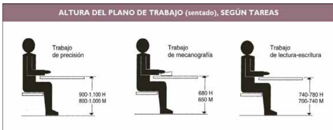
Figura 18. Altura del Plano de Trabajo (Según Tareas)
