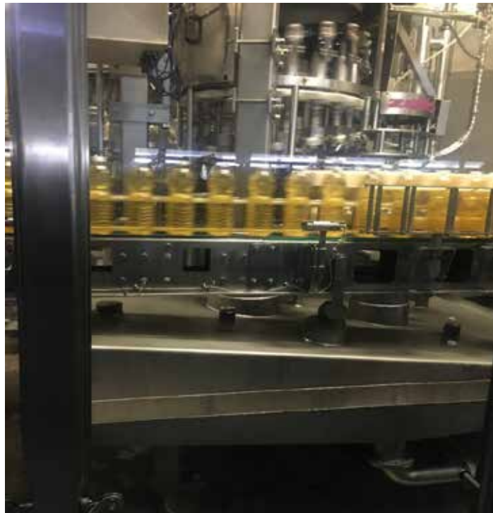
Figura 10. Botellas Llenas de Aceite saliendo hacia el Checkmat, luego de completar la etapa de la Llenadora.
