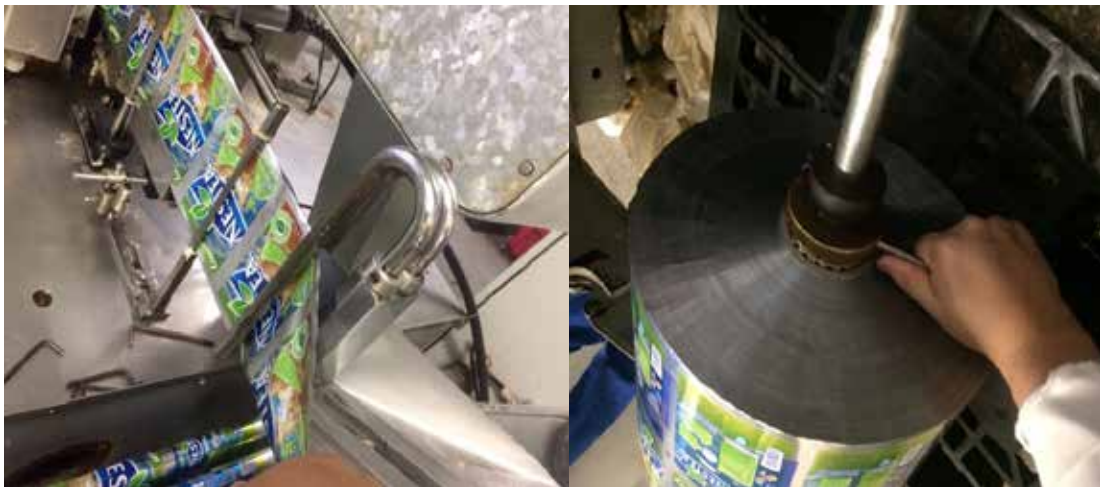
Figura9. Falta de agarre de los folios en el sistema de transferencia Fuente: Estrada, O y Sthory, G. (2017)
