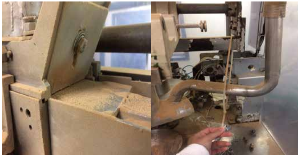
Figura 16. Fuga del producto (Desperdicios) durante el sistema de llenado Fuente: Estrada, O y Sthory, G. (2017)
