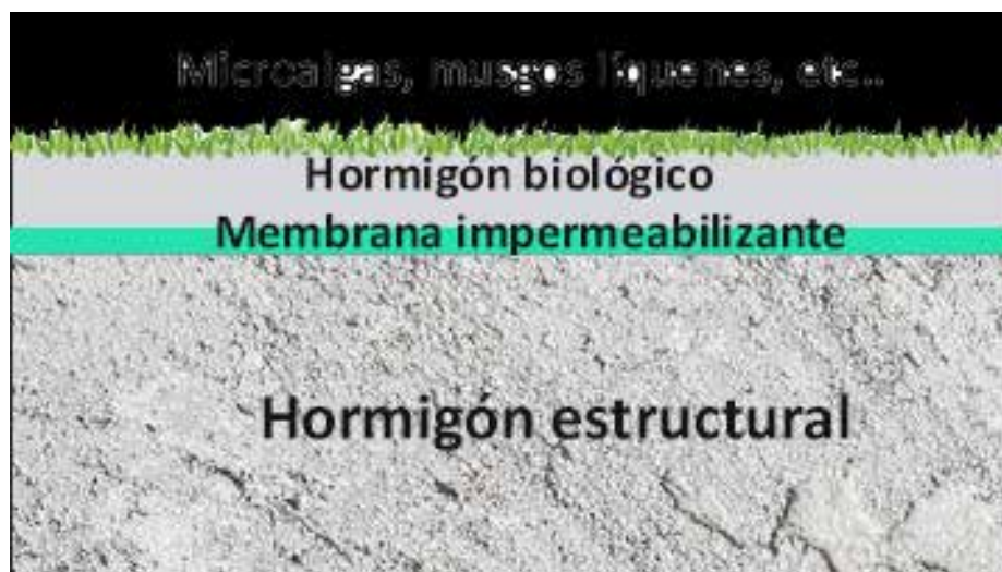
Corte de concreto biológico.
