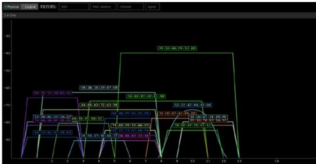
Figura 15. Solapamiento de canales entre los diferentes enrutadores de la zona. Fuente: El autor
