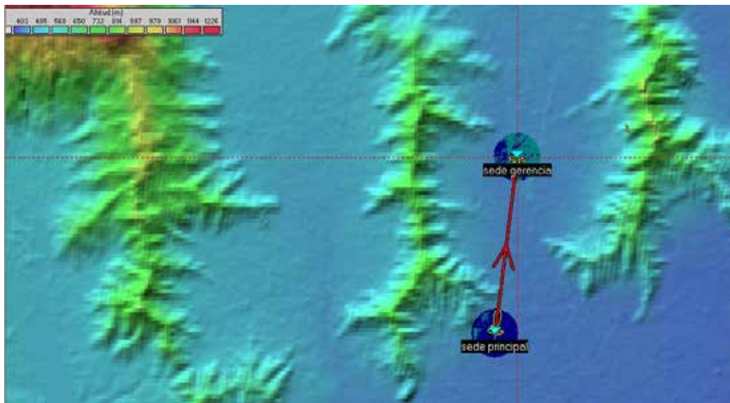
Figura 16. Simulación en Radio Mobile del enlace actual DPIACA.
