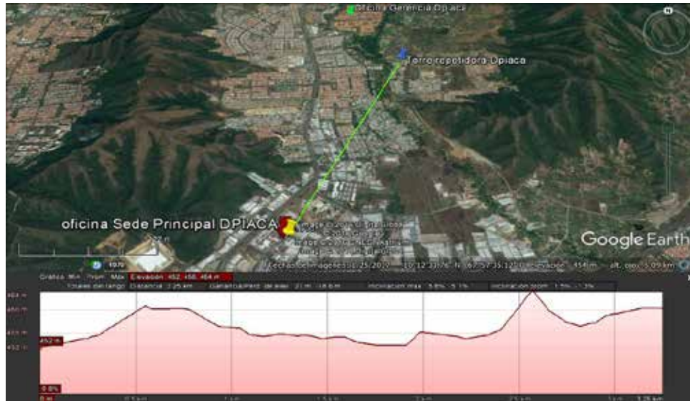
Figura 21. Perfil Topográfico del trayecto del edificio de operaciones DPIACA a base torre repetidora Fuente: Google Earth
