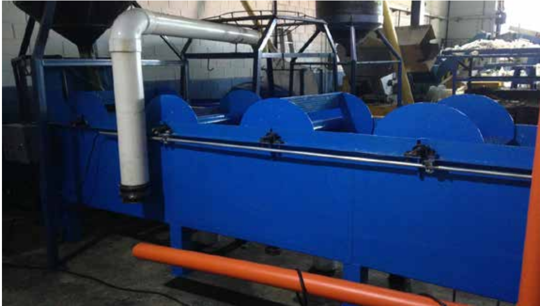
Figura 5. Proceso de lavado de las hojuelas ya cortadas. Fuente: Usón, D. (2018)
