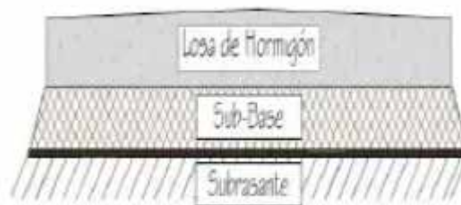
Figura 5: Estructura para un pavimento rígido
