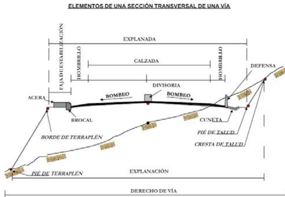
Figura 3: Elementos de una sección transversal
