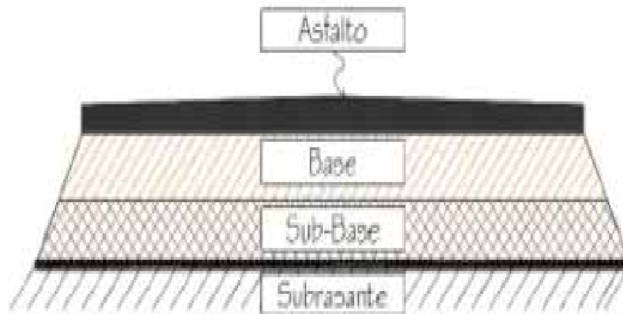
Figura 7: Capas de un pavimento flexible
