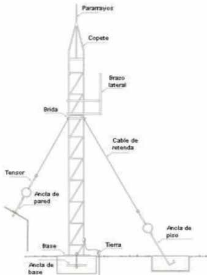
Figura 18: Partes de una torre soportada por ganchos Fuente: https://bibdigital.epn.edu.ec/handle/15000/10776
