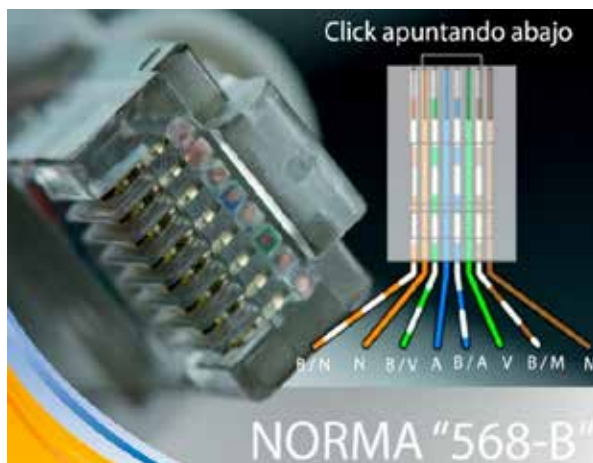
Figura 20: RJ-45 con Normativa TIA/EIA-568-B .
