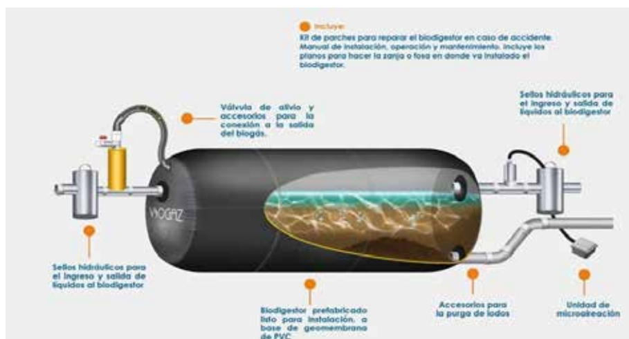
Imagen No. 15. Biodigestor. Fuente: VIOGAZ.
