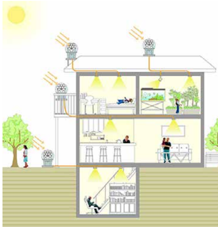
Imagen No. 17. Captadores solares. Fuente: Himawari.
