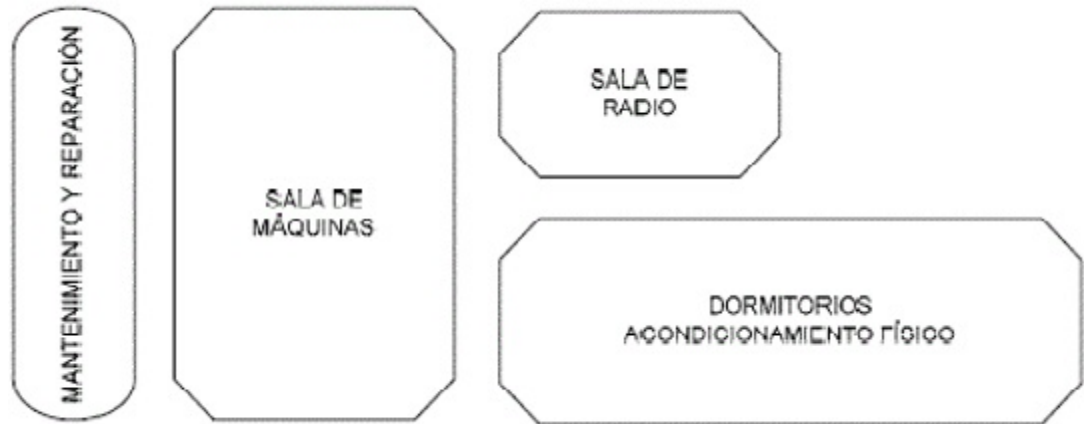
Figura 9. Esquema de Relación de áreas funcionales de la sala de máquinas Fuente Norma Venezolana, tomada de la Guía para el diseño de estaciones de bomberos (2019).
