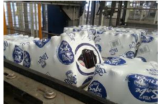
Imagen #12. Empaque mal posicionado
