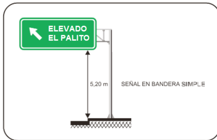
Figura 18 .Señalización vial para el Elevado el Palito
