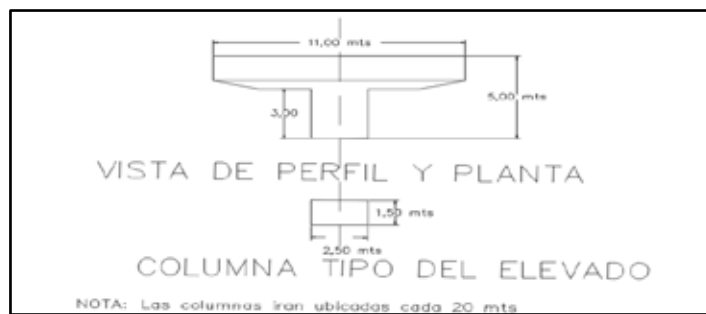
Figura 20. Ubicación de las Columnas del elevado
