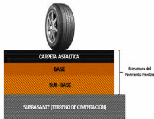
Figura 41: Estructura de pavimento flexible.
