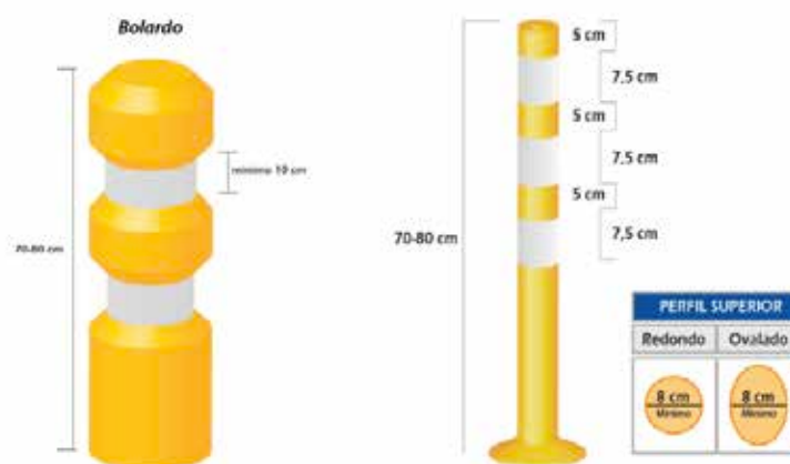
Figura 30: Dimensiones de bolardos verticales en vías segregadas.
