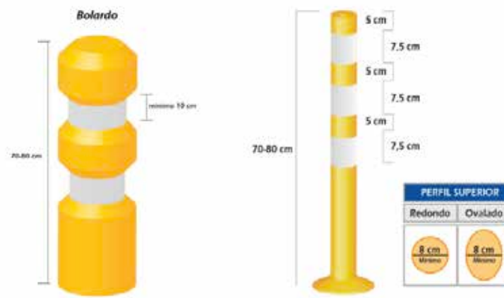
Figura 28: Dimensiones de bolardos verticales en vías segregadas.
