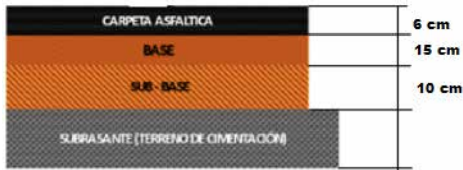
Figura 45. Despiece de la estructura del pavimento.
