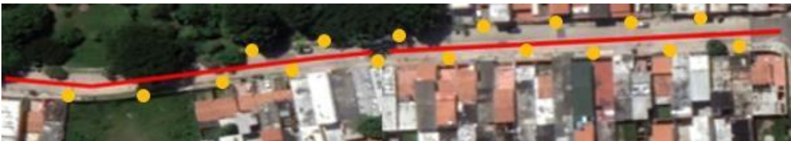
Figura 48: Ubicación de postes de luz presentes en el tramo 7 y 8
