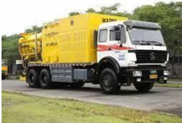
Figura 9: Camión para mantenimiento vial para pavimento asfáltico poroso.
