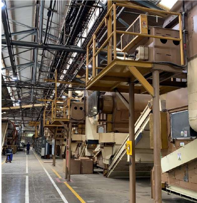
Figura 6. Condiciones actuales máquinas Separadores RPL y Fajas Transportadoras en el área de Desvenado y Clasificación de la planta GLT Fuente: Pérez R. (2023)
