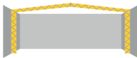
(Fig. 29) Cerchas metálicas para salvar luces grande
