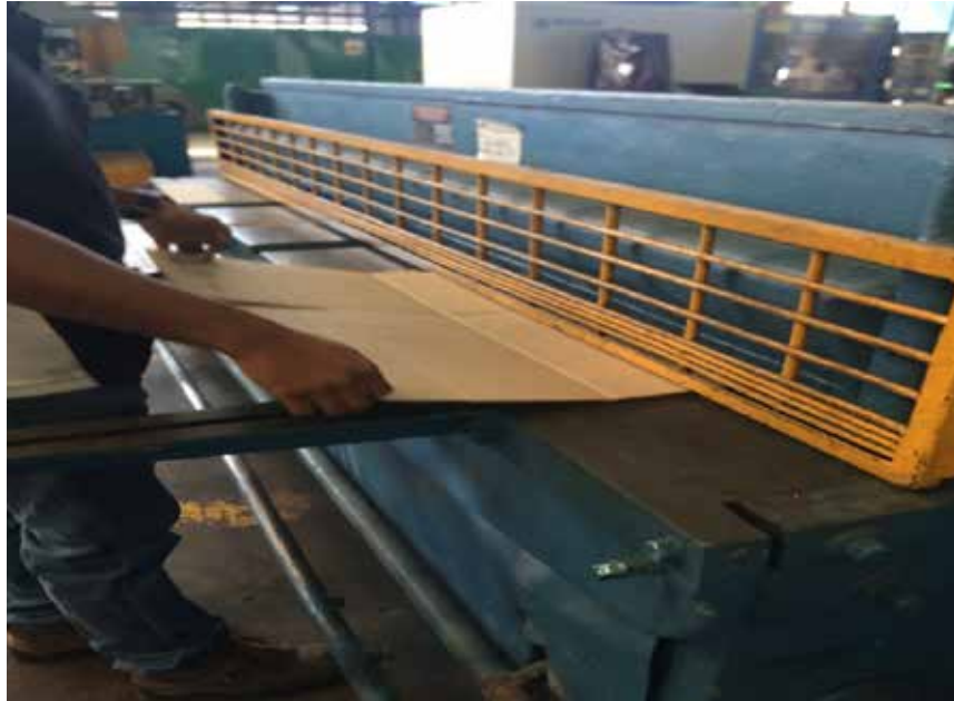
Figura 8. Cizalla línea aire industrial
