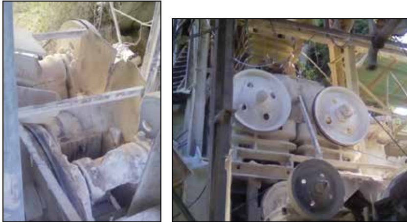
Figura 8. Repasadora Primaria, compuesta por dos quebrantadoras de mandíbulas medianas
