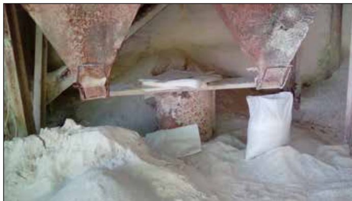
Figura 33. Pérdida de material durante el llenado de sacos
