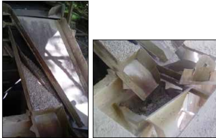
Figura 17. Canales de gravedad y entrada del material cribado a los silos
