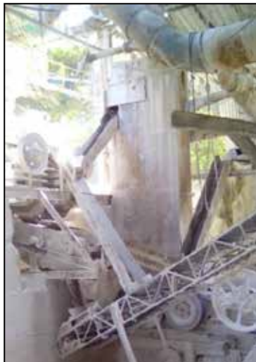
Figura 19. Cinta Transportadora y entrada de material de retorno al molino Fuente: Acuña, 2018
