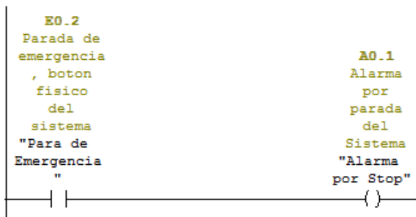
Figura 33. Alarma por parada de emergencia
