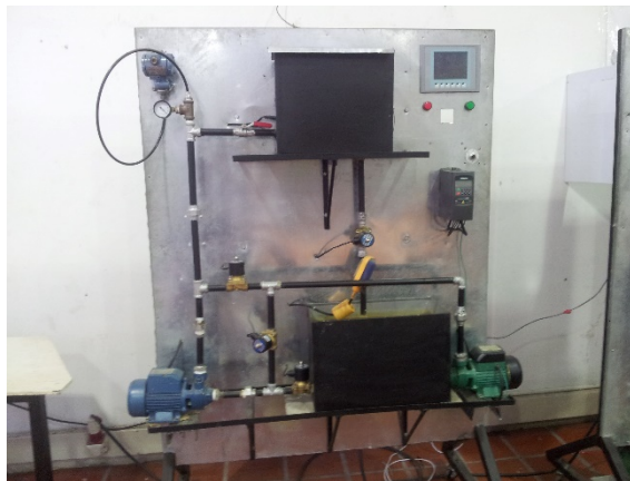
Figura 14: Banco de pruebas serie paralelo por ATSIngenieria
