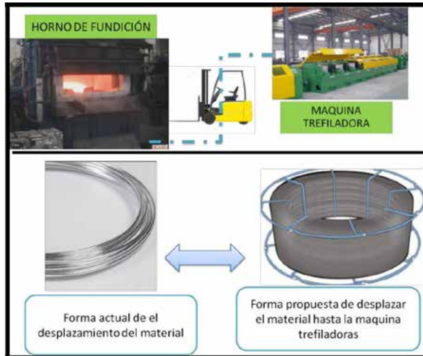
Figura N°19: Proceso de desplazamiento del material
