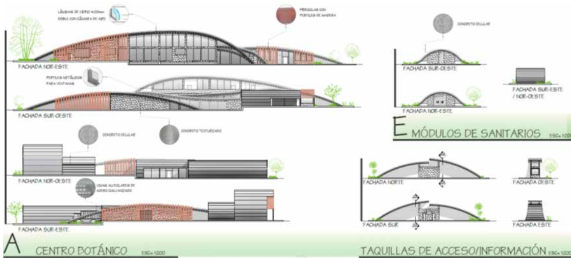
Figura 42: Fachadas del conjunto con especificación de materiales. Fuente: Propia
