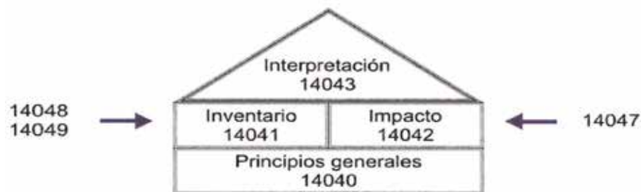
Figura 34 – Estructura del análisis de ciclo de vida con las normas ISO/TR que influyen en cada etapa
