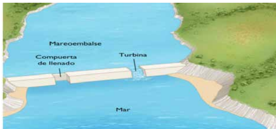
Figura 5 - Presa de marea
