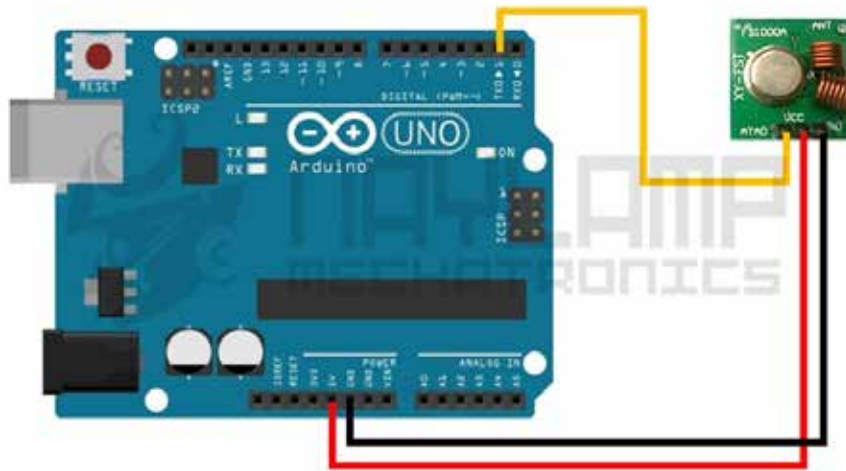
Figura 25. Conexión del módulo RF para el emisor.
