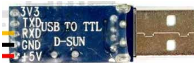
Figura 24. Conversor USB – SERIAL Fuente: Mendoza, S. (2019)
