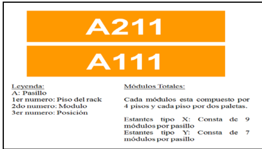
Figura N° 30: Etiqueta del sistema único de codificación de los racks.
