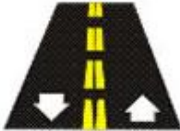
Figura 12: Línea Doble de Trazo Discontinuo.
