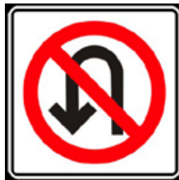
Figura 80: Señalización vertical, prohibido vuelta en U
