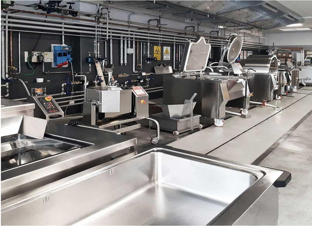
Figura 1. Elementos y maquinaria de cocina industrial hechos con acero inoxidable. Fuente: Firex (2023)
