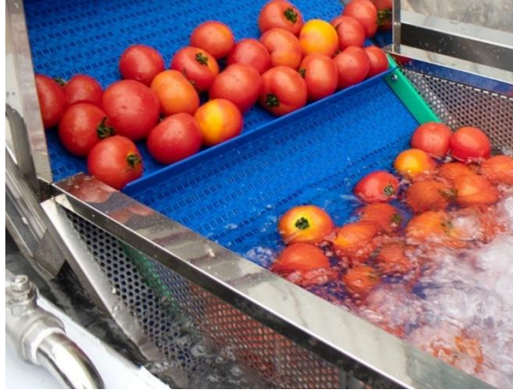
Figura17. Lavadora de frutas por principio de inmersión. Fuente: Agrimaquinas.com (2023)
