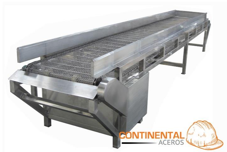
Figura 8. Sistema de cinta transportadora de malla. Fuente: Aceros Continental (2015)
