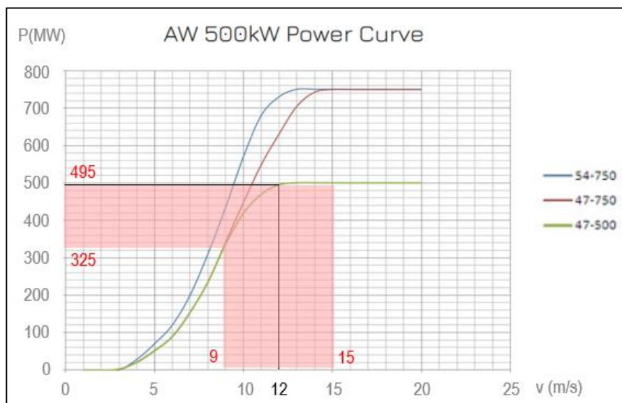
Figura 27: Rango de potencias según la distribución de Weibull para el modelo AW500-47
