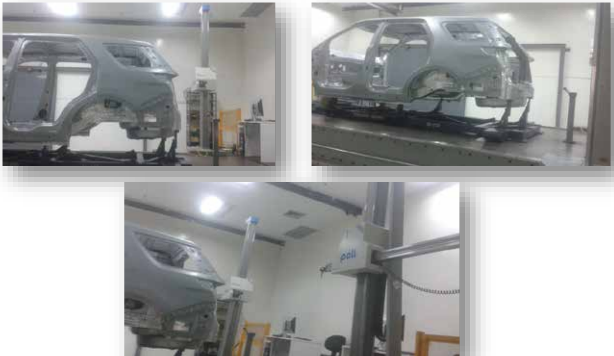
Figura 13. Medición de puntos de control en el CMM Fuente: Departamento de Control Dimensional
