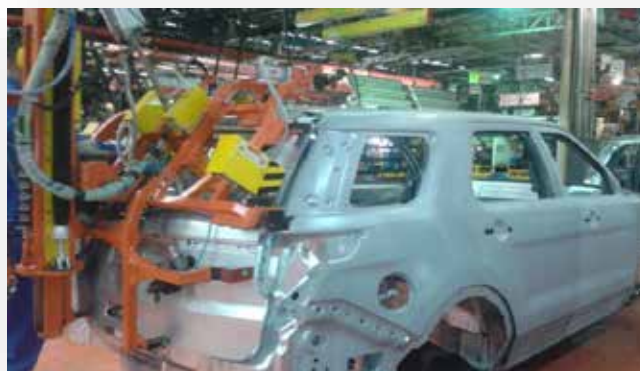
Figura 22. Instalación de compuerta de acabado metálico Fuente: Marbella González y Departamento de Carrocería
