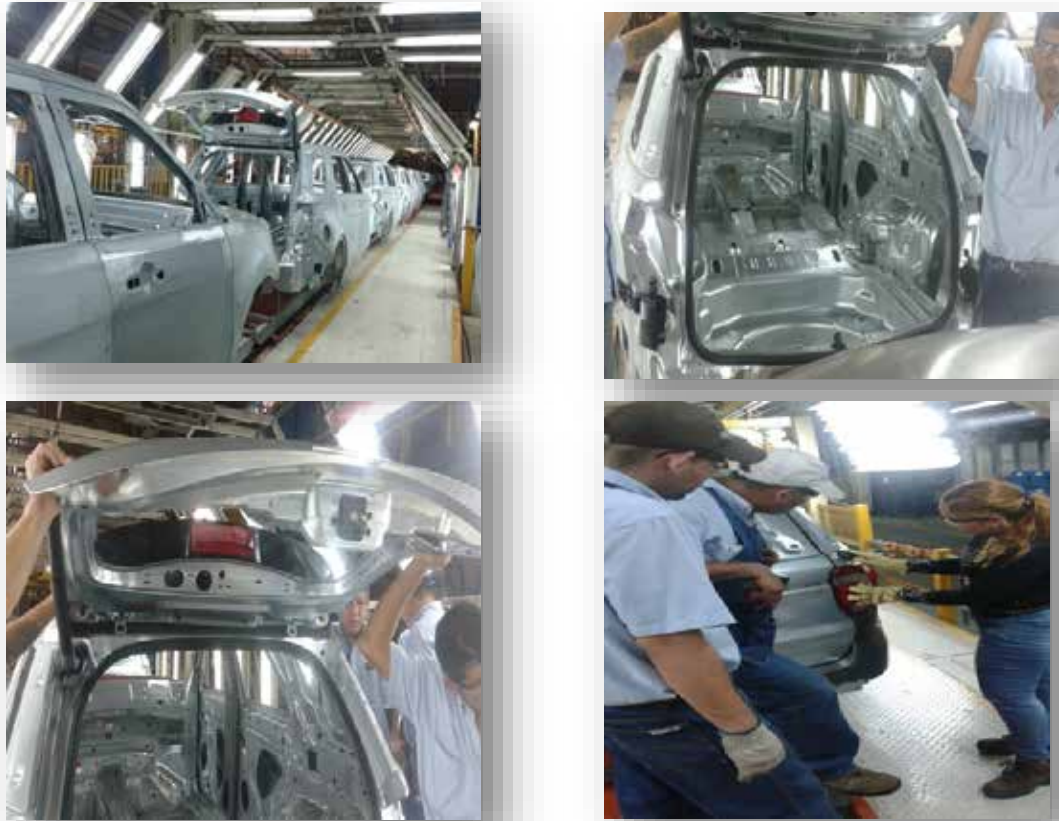
Figura 26. Instalación de compuerta y accesorios en U502 Fuente: Área de Acabado Metálico
