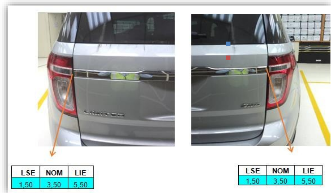
Figura 8:holgura y enrase compuerta vs costados ambos lados en U-502 Fuente: Marbella González
