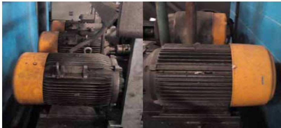
Figura 25. Motores acoplados a bombas de la prensa Denison&Leffler II
