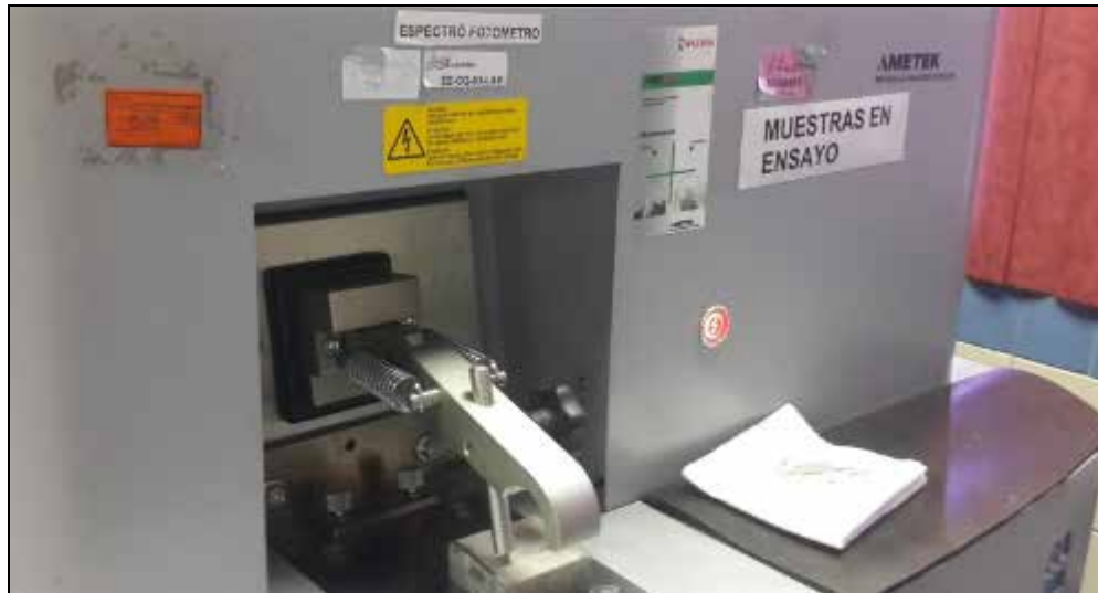
Figura 26: Espectrómetro de emisión óptica marca METEK- SPECTROMAXx Fuente: Laboratorio de Fundición, empresa EXTRUDAL, C.A. (2.018)
