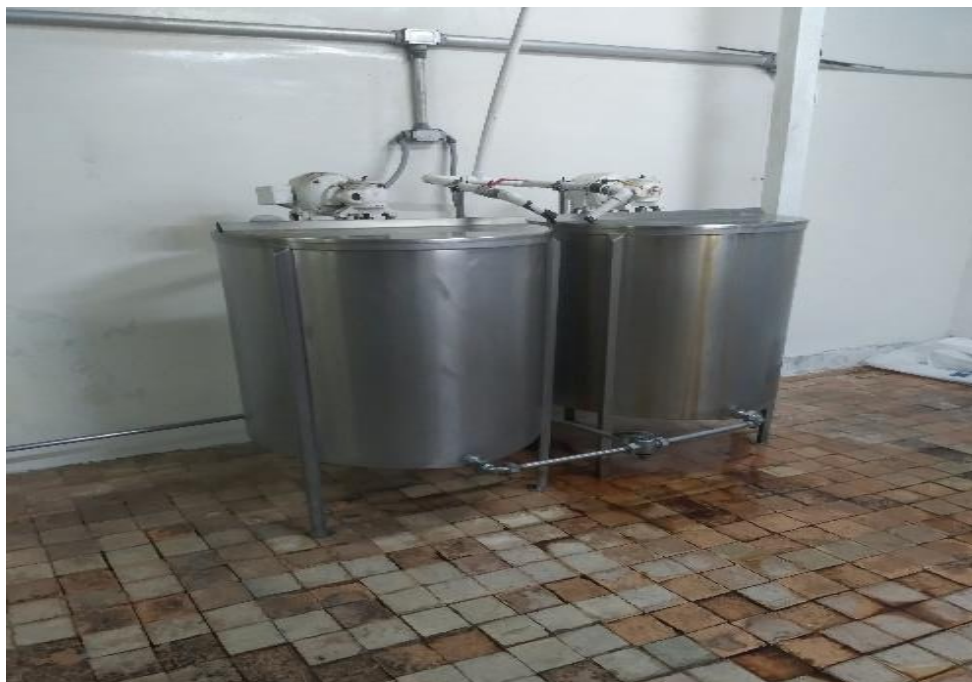
Figura 2. Tanques de premezclado del producto A, B y C. Fuente: Luis Natera (2022).
