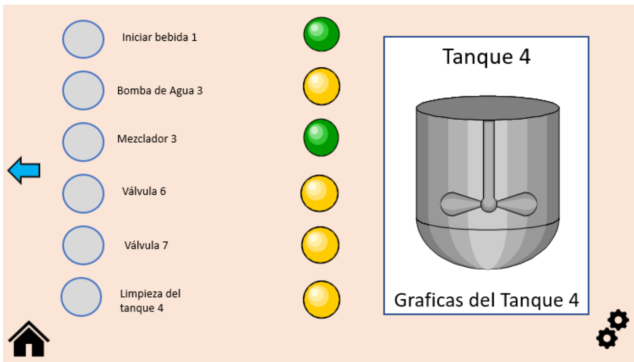
Figura 36. Pantalla de activación del proceso de bebida en el tanque 4. Autor: Luis Natera (2023).
