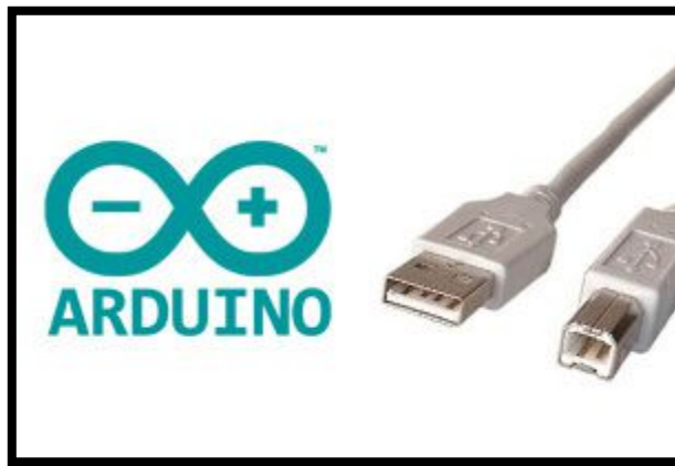
Figura 17: Cable de alimentación del Arduino
