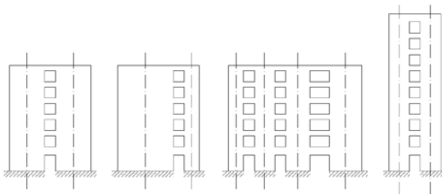
Figura 19. Tipos de muros acoplados.
