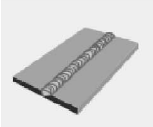
Figura 14. Soldadura de penetración.
