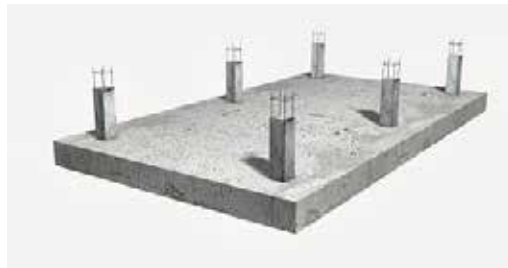
Figura 26, Viga de Arriostamiento y Losa de Fundación. Fuente :La Autora.(2015).
