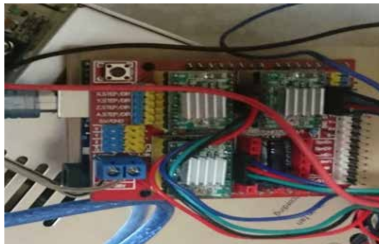
Figura 22. Conexión de los drivers al controlador.
