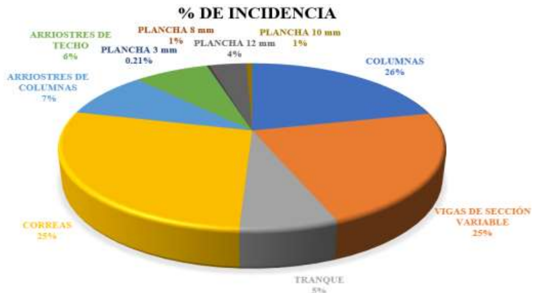
Gráfico 11.- Porcentaje de incidencia para la nave industrial con 18 metros como ancho de pórtico (perfiles: tubulares)
