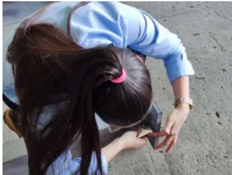
Figura 10.- Medición de espesores a mano con ayuda de la herramienta Galga para conexión perfil - plancha.
