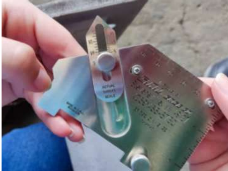
Figura 9.- Espesor de las soldaduras.
