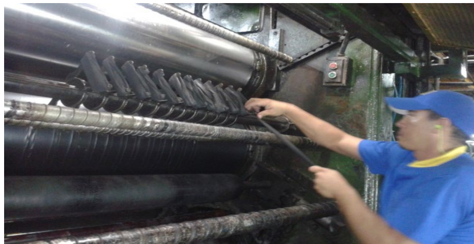
Figura N° 4: situación actual de colocación de cuchilla. Autor: Lozano, W. (2015).
