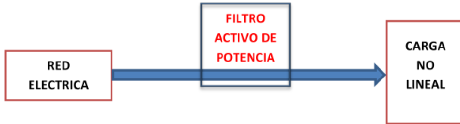
Figura 8. Esquema general de un APF dentro de una red.
