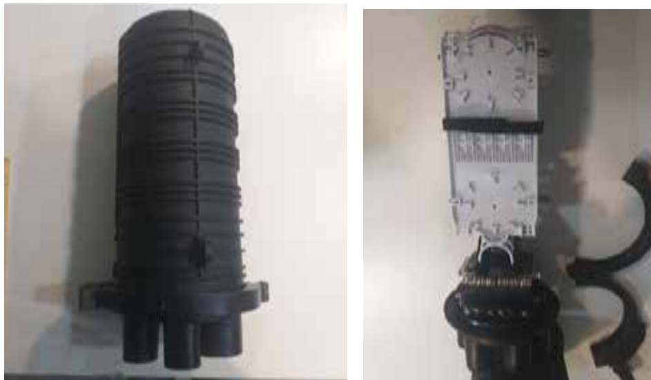
Figura 38. Manga con capacidad para fibra de 96 hilos Fuente: Piñango. J. (2020)
