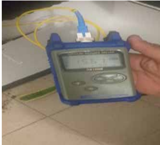
Figura 60. Prueba de potencia en caja NAP. Fuente: Piñango. J. (2020)
