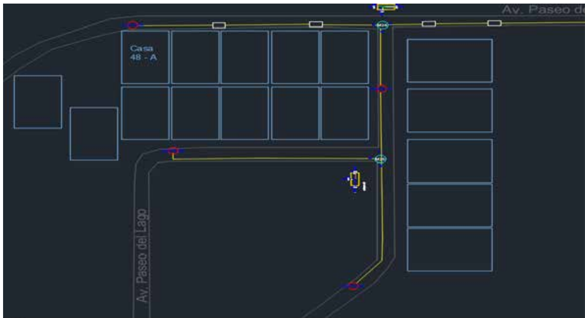
Figura 35. Distribucion de cajas NAP a nivel de casas.
