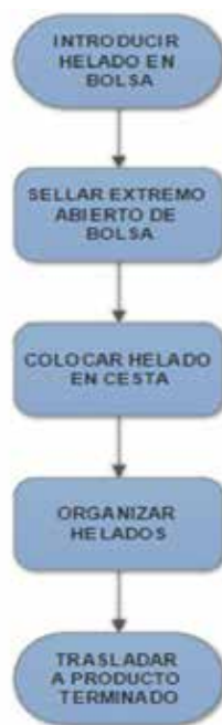
Figura 9: Diagrama de flujo empaquetado y almacenado
