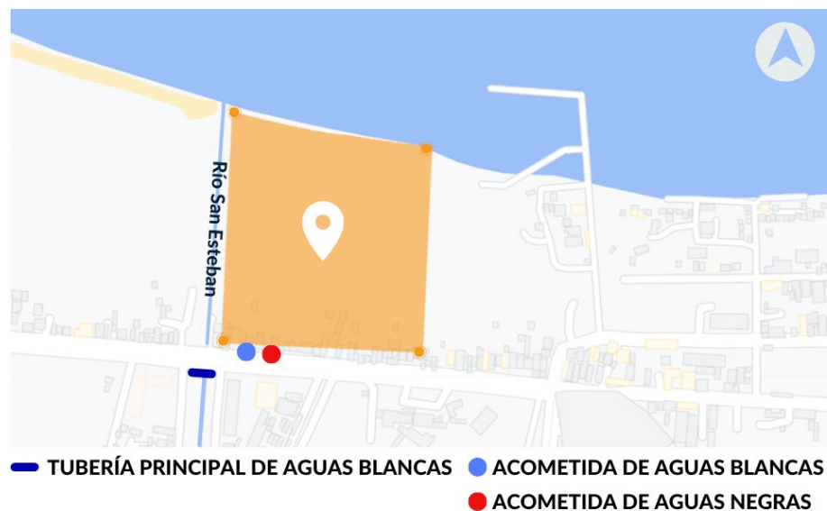
Figura 7: Acometidas de aguas blancas y aguas negras en el terreno en estudio. Fuente: González, B. (2023).
