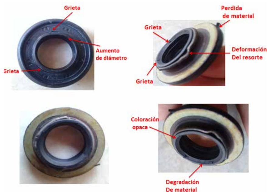
Figura 21: Analisis visual del envejecimiento en la estopera.
