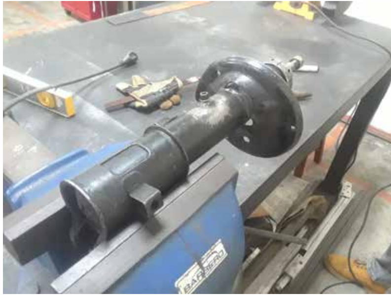
Anexos A. Apertura y evaluación de amortiguadores
