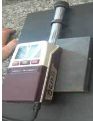
Figura 13: Analisis de rugosidad con Mitutoyo SJ-201.
