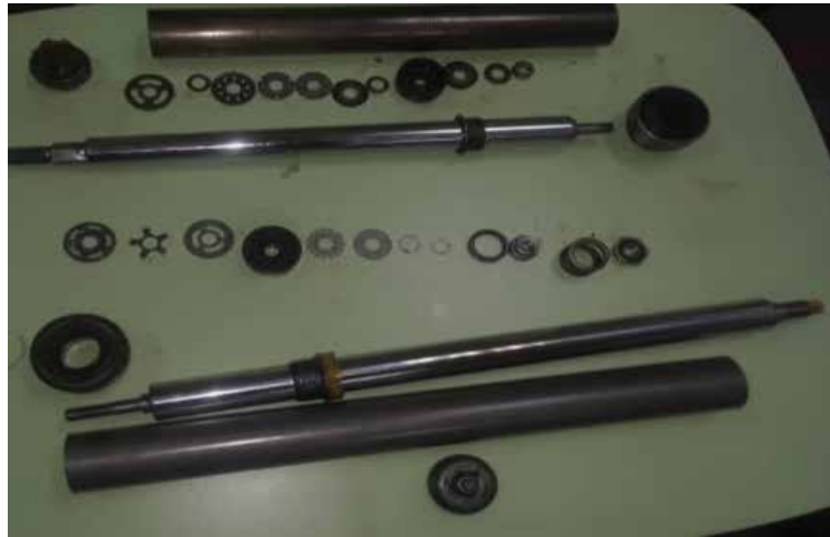
Figura 12: Ejes para analisis de rugosidad. Fuente. Sanchez J. y Quintero F. (2020)
