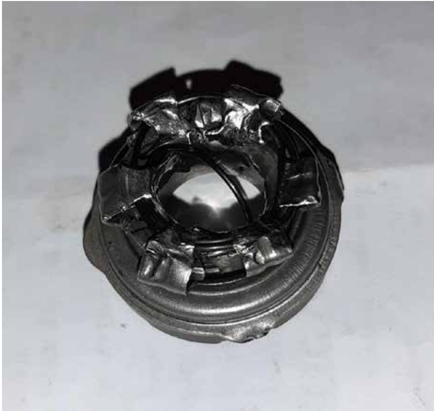
Anexos A. Válvula de compresión dañada
