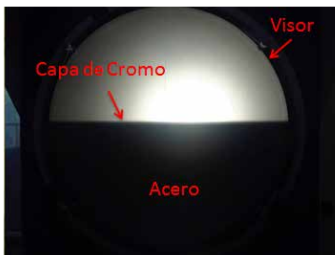
Figura 14: Vista del análisis perfilométrico de un eje Fuente. Sanchez J. y Quintero F. (2020)
