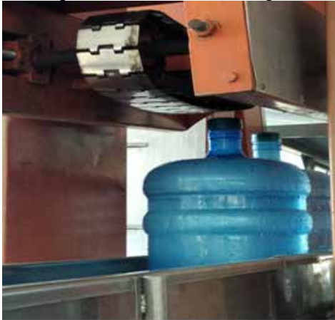
Figura 13. Banda Transportadora para el despacho de Botellones
