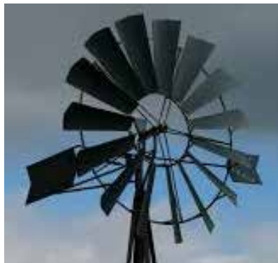
Figura 1. Molino de viento de eje horizontal enfocado en bombeo de agua.
