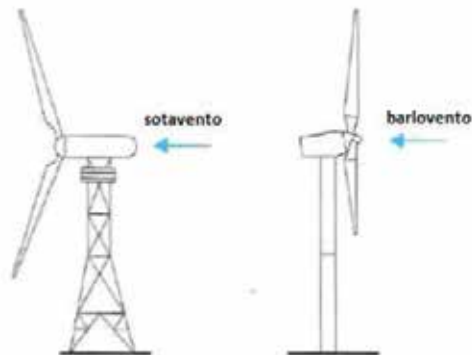
Figura 3. Aerogeneradores a Sotavento y Barlovento.
