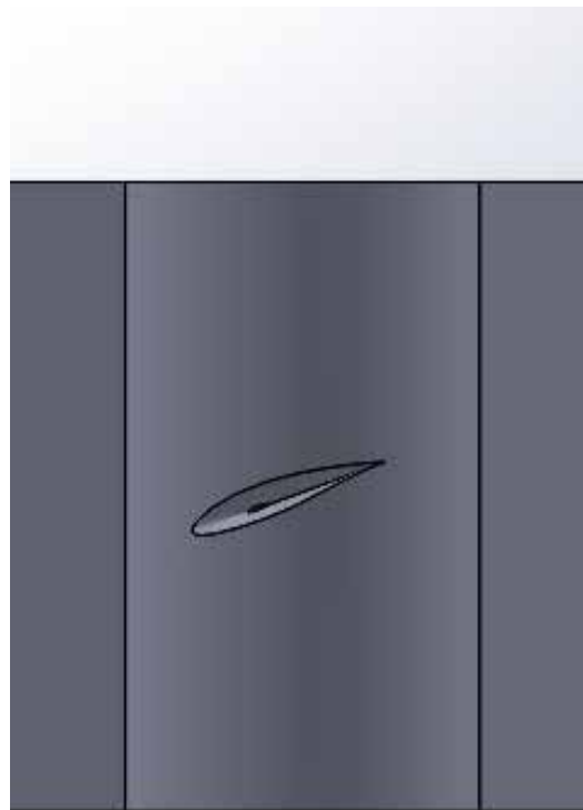
Volumen de control finalizado SG6040 – Angulo de ataque 20° Vista frontal.
