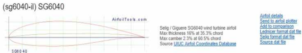
Figura 27. Perfil del álabes SG6040.
