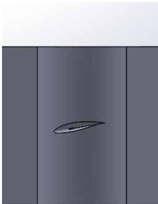
Volumen de control finalizado SG6040 – Angulo de ataque 10° Vista frontal.
