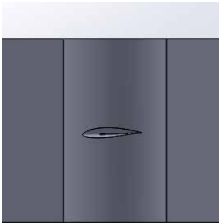
Volumen de control finalizado SG6040 – Angulo de ataque 2° Vista frontal.
