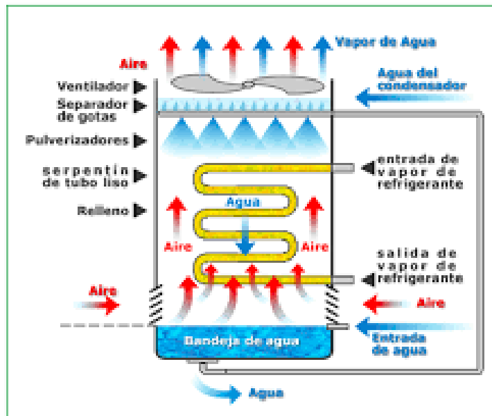
Figura 9. Componentes Torre de enfriamiento.
