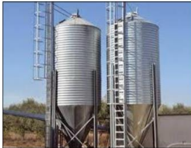
Figura 20. Silo para almacenaje de expeller o acopio de soja Fuente: Agroads (www.agroads.com, 2023)
